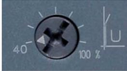
En el potenciómetro U se ajusta el valor de la tensión de arranque. El valor de la tensión de arranque determina el valor del par de arranque del motor. Una tensión de arranque menor produce un par de arranque menor (arranque más suave) y una corriente de arranque menor.
