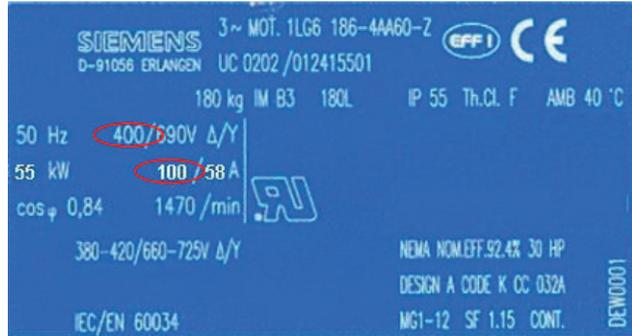
En el potenciómetro  $I_e$  la intensidad asignada de empleo de motor debe ajustarse de acuerdo con la tensión de red aplicada o la interconexión del motor (estrella/triángulo). La protección electrónica de sobrecarga del motor se refiere a este valor ajustado cuando está activada. Ver valores de ajuste admisibles referidos a la clase de disparo por sobrecarga del motor deseada en el capítulo Valores de ajuste de corriente del motor (Página 119).
