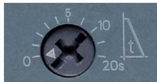
El tiempo de parada puede ajustarse en el potenciómetro  $t$ . Con ello se determina durante cuánto tiempo debe seguir alimentándose el motor tras retirarse el comando CON. Dentro de este tiempo de parada, el par generado en el motor se reduce mediante una función de rampa de tensión y la aplicación se detiene con suavidad.
