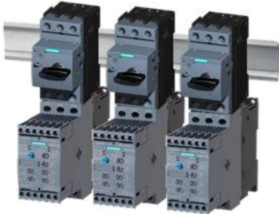
Si no se alcanza la distancia  $b$  hacia arriba indicada en el capítulo Dimensiones de montaje, distancias  $a$  a observar y tipo de instalación (Página 64), p. ej., cuando el arrancador suave se adosa directamente a un interruptor automático (p. ej., 3RV2) mediante un módulo de unión (p. ej., 3RV29), se habla de instalación directa.
